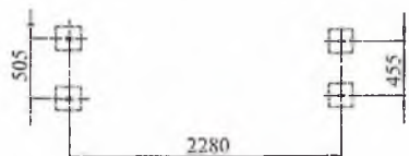
Scheme of the post placing with foundations (Схема расположения фундаментов со стойками)
